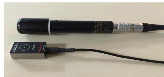
Fig. 2 上;電離箱 (6 ml), 下;半導体検出器
